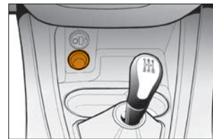
Рис. 2. Розетка для подключения дополнительного электрооборудования
