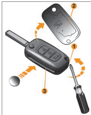
Рис. 10. Замена элемента питания пульта дистанционного управления
