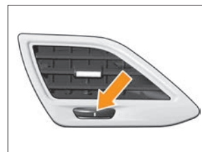
Рис. 8. Боковое левое сопло вентиляции салона (ручка управления заслонками сопла в положении «ЗАКРЫТО»)
