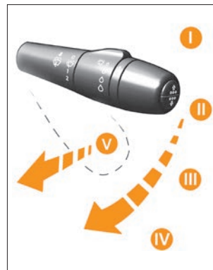
Рис. 17. Рычаг переключателя стеклоочистителей
