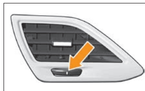
Рис. 8. Боковое левое сопло вентиляции салона (рукоятка управления заслонками сопла в положении «ЗАКРЫТО»)
