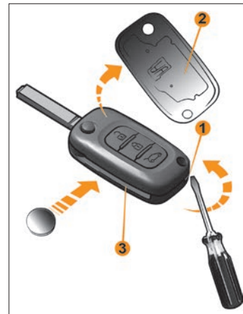
Рис. 10. Замена элемента питания пульта дистанционного управления
